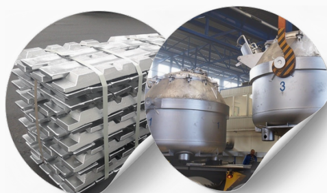
Výsledný produkt je dodáván buď ve formě hliníkových ingotů (cihliček), nebo tekutý míří k dalšímu zpracování.
