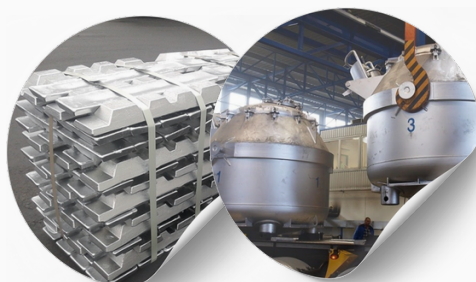
Výsledný produkt je dodáván buď ve formě hliníkových ingotů (cihliček), nebo tekutý míří k dalšímu zpracování.
